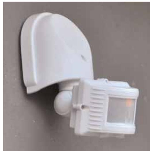
Sensore a infrarossi passivi PIR
